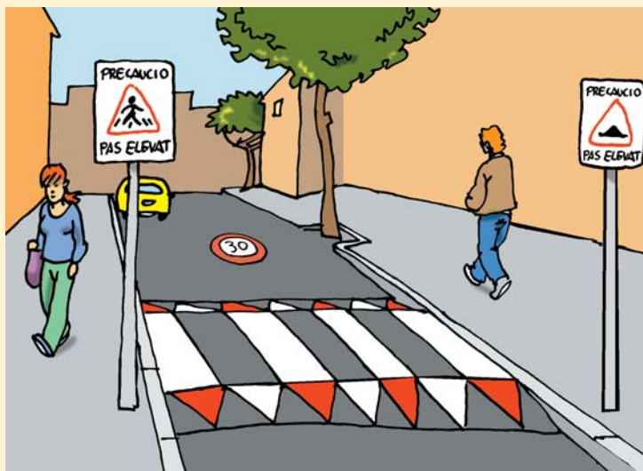
Paso de peatones elevado sobre calzada. La se nalizaci n horizontal y vertical advierte de la elevaci n de la calzada para el paso de peatones elevado.
